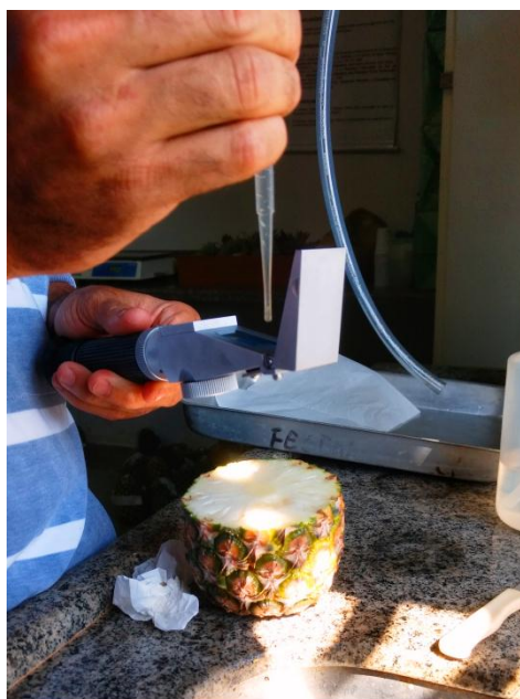
Figura 14: Avaliação do °Brix do fruto de abacaxi através do refratômetro em Ceres, GO, 2017
